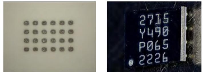
图31: (左) 将锡膏模版涂到陶瓷衬底上。(右) 回流到衬底上后的EPC2715
