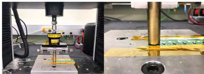
图27: 压力测量仪。以每分钟0.6 mm的恒定加载速度,把测试仪的头端放置到器件的背部,直至测量仪感应到预设力度为止。用表面安装方法,把DUT安装在FR4测试试样上,在测试台上把试样固定
